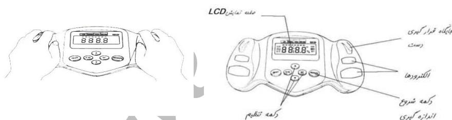
شکل ۱ - دستگاه چربی‌سنجه دیجیتالی مدل Citizen BM 100 و طرز استفاده از آن
