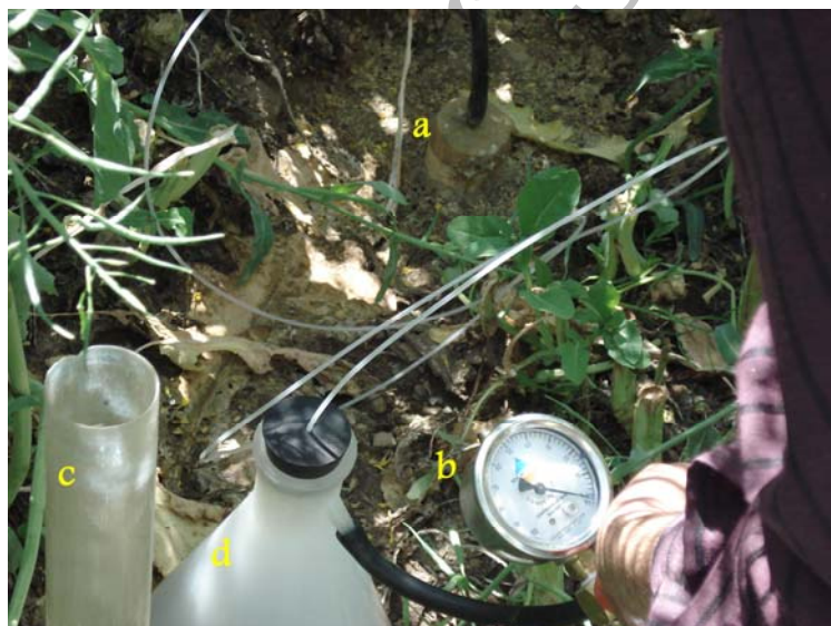
شکل ۲- وسایل نصب شده به منظور کنترل رطوبت و تهیه نمونه زه‌آب a = Soil Water Sampler; b = Vacuum Hand Pump; c = tube of T.D.R.; d = Vessel of collection.
