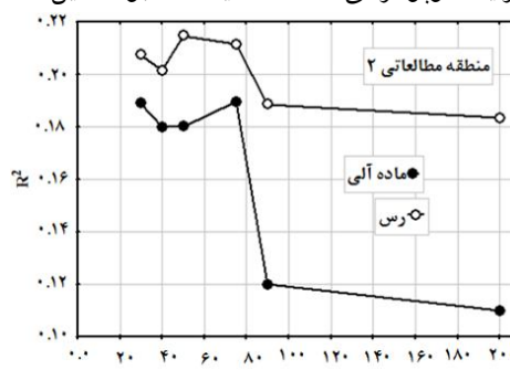
شکل 10- دقت تخمین ماده آلی و رس خاک از مدل رقومی ارتفاع با ابعاد متفاوت
