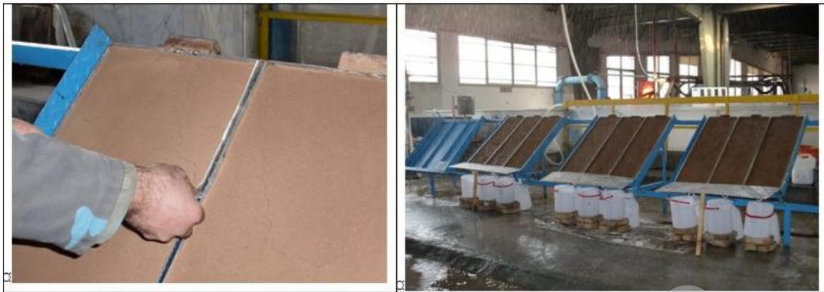
شکل 3- نمایی از فلوم، تشک‌های فلزی (به طول 100، عرض 35 و ارتفاع 6 سانتیمتر) و دستگاه شبیه‌ساز باران
