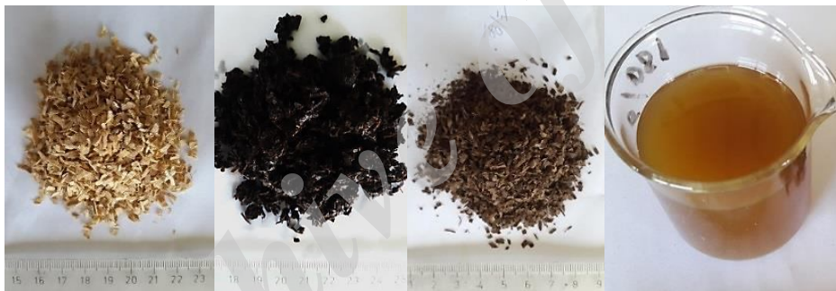
شکل 2- به ترتیب از چپ به راست: خرده‌های چوب، هیدروچار مرطوب، بخش جامد هیدروچار و بخش مایع هیدروچار
