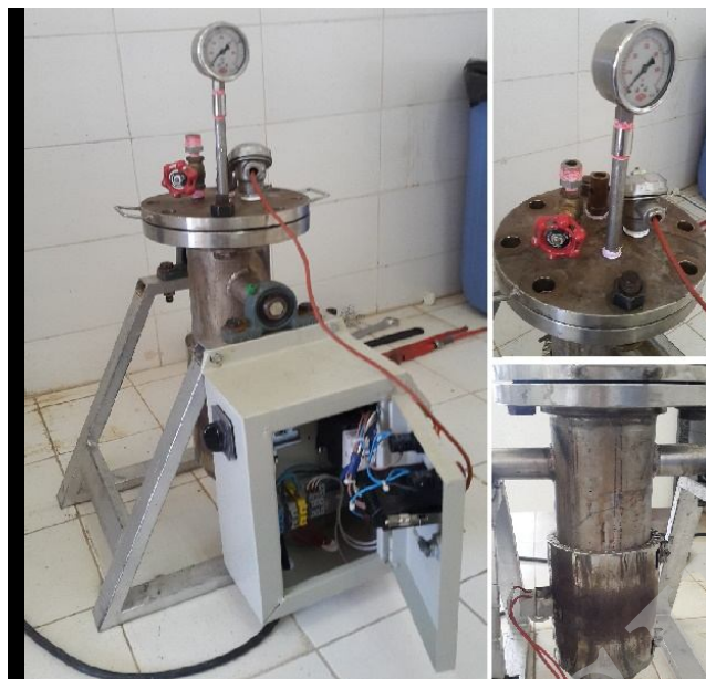
شکل 1- تصویر رآکتور HTC ساخته شده در این پژوهش
