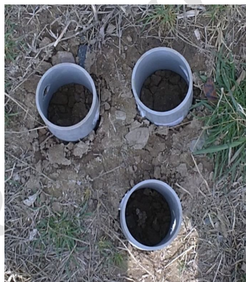
شکل 1- تهیه نمونه‌های خاک دست‌نخورده (با سه تکرار) با فرو کردن لوله‌های استوانه‌ای از جنس PVC در خاک
