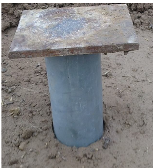
شکل 1- تهیه نمونه‌های خاک دست‌نخورده (با سه تکرار) با فرو کردن لوله‌های استوانه‌ای از جنس PVC در خاک
