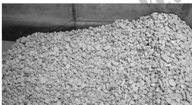
شکل ۱۱- نیم‌رخ موج‌شکن سکویی تغییر شکل یافته و چگونگی توزیع سنگها روی آن
