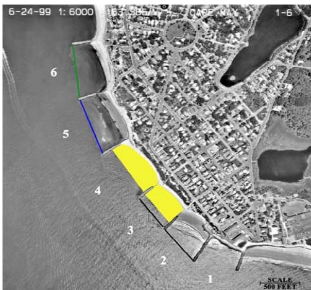
شکل ۱- آب‌شکن‌های احداث شده (عمود بر ساحل) برای تثبیت سواحل نیوجرسی، آمریکا [Giovannozzie et al., 2003]
