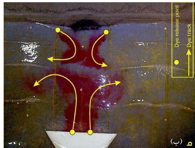
شکل ۲- الگوی جریان پشت موج شکن برای مدل SNCL1-250 الف- محاسبه شده توسط مدل عددی، ب- ردیابی شده برای مدل فیزیکی Ranasinghe و همکاران (۲۰۰۶)
