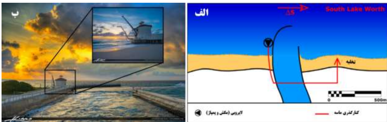
شکل ۴: طرح شماتیک (الف) و تصویر (ب) ایستگاه سامانه کنارگذری ورودی کانال دریاچه ورت جنوبی (Loza, 2008)
