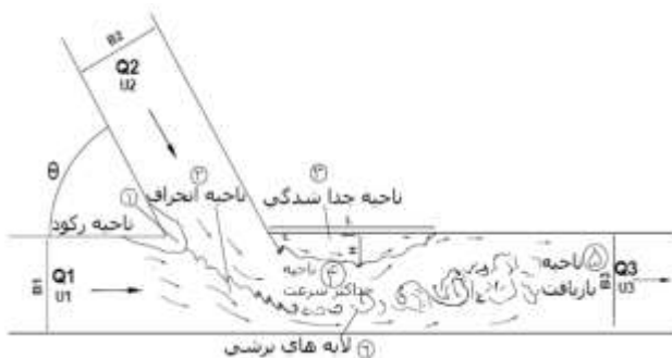
شکل ۱۸: نمونه‌ای از الگوی جریان در محل تقاطع کانال‌های باز یا رودخانه‌ها (Gohari and Amraei, 2014).
