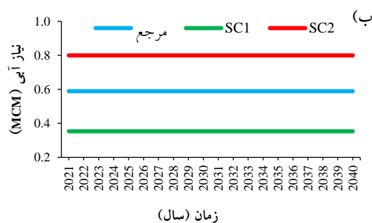
شکل ۸- میزان تقاضای نقطه نیاز شهر تبریز (الف) و کشاورزی نهند (ب) برای دوره ۲۰۲۱-۲۰۴۰ تحت سناریوهای تدوین شده در مدل WEAP در حوضه آبریز نهند
