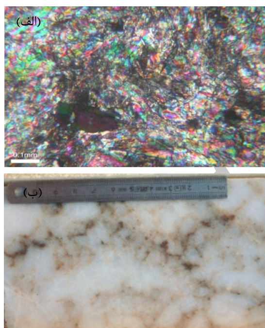
شکل ۵ الف) تصویر میکروسکوپی از انیدریت لایه‌ای با بافت متراکم و درهم فشرده (واحد مخزنی K4- عمق ۳۲۶۰/۷۰). ب) تصویر مغزه از لایه انیدریت.
