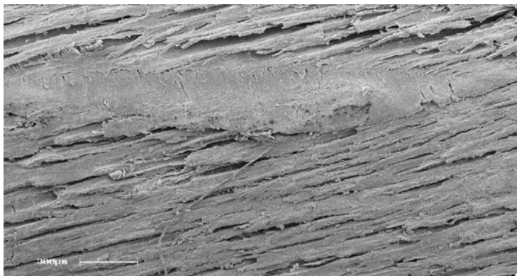
شکل ۷- تصویر میکروسکوپ الکترونی سطح شعاعی چوب راش، طی ۳۰۰ ساعت هوازدگی.
