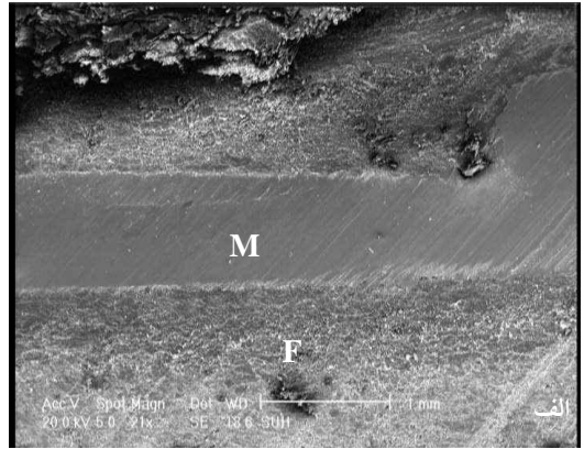
شکل 4- تصویر میکروسکپ الکترونی از سطح اتصال شبکه‌های فلزی با الیاف؛ الف: شبکه آغشته شده به چسب اپوکسی پیوستگی همه جانبه فلز با چسب اپوکسی درون تخته را نشان می‌دهد؛ ب: شبکه فلزی بدون آغشتگی اولیه که می‌توان خط فاصله بین رشته و الیاف را دید؛ M: فلز؛ F: الیاف
