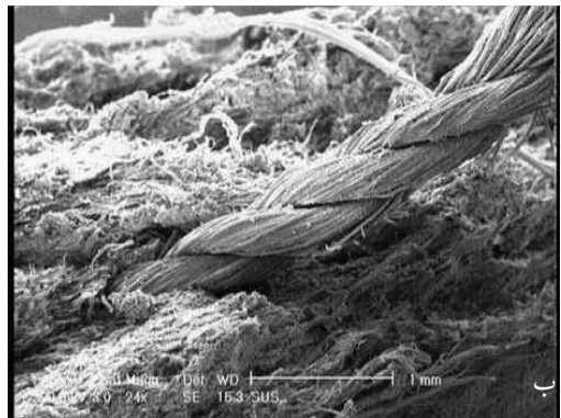
شکل 5- تصویر میکروسکپ الکترونی از سطح اتصال شبکه‌های مصنوعی بافته با الیاف؛ الف: مقطع شکست نمونه، ب: محل برش
