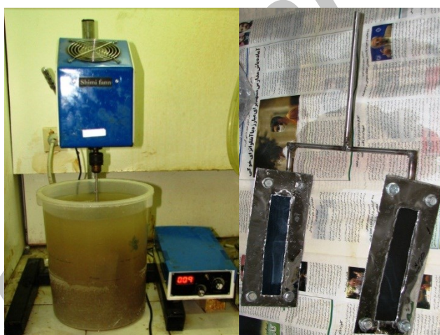
شکل ۲- دستگاه همزن و پره‌های مورد استفاده برای اندازه‌گیری مواد چسبناک میکرو.
