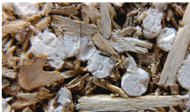
شکل ۱- نمایی از پلیمر و خرده چوب در تخته ساخته شده.
