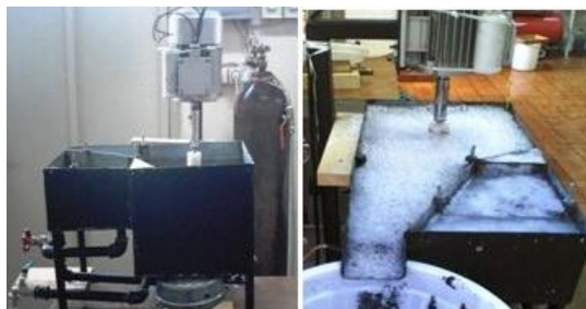
شکل ۲- تصویر دستگاه شناورسازی برای جداسازی ذرات مرکب.
