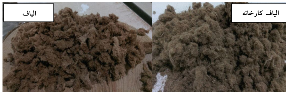
شکل ۳- الیاف کارخانه و الیاف بازیافت شده. Figure 3. Factory fiber and recycled fiber.
