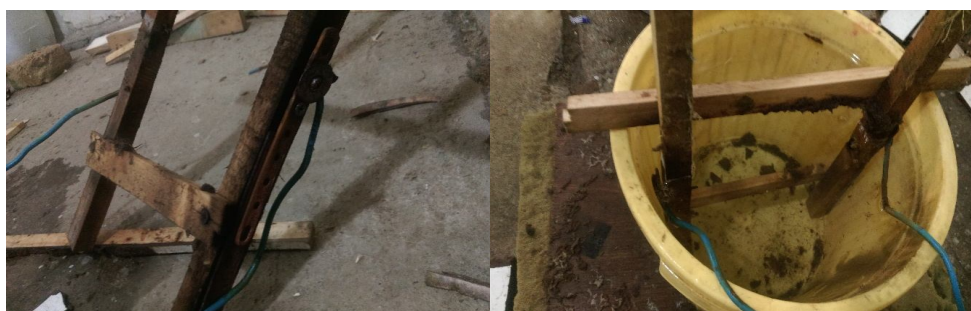
شکل ۱- محفظه پلاستیکی با الکترودهایی از جنس استیل.
