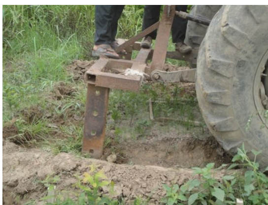
شکل ۳- هرس افقی ریشه نهال‌های ریشه لخت بلندمازو با استفاده از تیغه افقی متصل به تراکتور.
