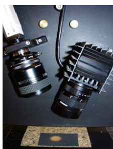
شکل ۲- تجهیزات اندازه‌گیری تغییرات درخشش چاپ. دست چپ دستگاه تابنده نور ۱ و دست راست دوربین قرار دارد. این دستگاه در انستیتو تحقیقاتی خمیر و کاغذ سوئد ساخته شده است و در حال حاضر در آنجا قرار دارد (مک گرگور و جانسون، ۱۹۹۰).
