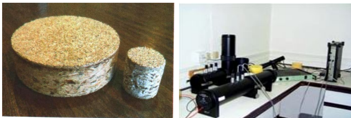
شکل ۳- تراز سنج صدا مدل ۲۲۵۰ و نمونه‌های آزمون.
