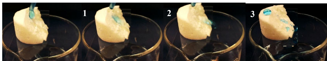
شکل ۸- الف) زاویه تماس تعادلی آبروژل سلولزی آبریز، ب) مکانسیم پیشنهادی واکنش میان پیوند دهنده عرضی و زنجیره سلولز، پ) بررسی خاصیت آبریزی در سطوح میانی آبروژل (از چپ به راست).
