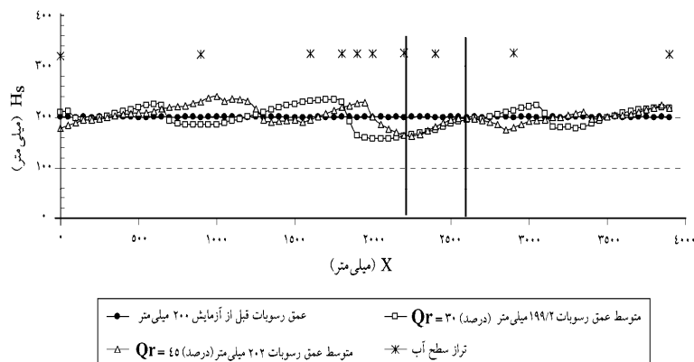
شکل ۷- پروفیل بستر قبل از شروع آزمایش‌ها و پس از رسیدن به تعادل.
