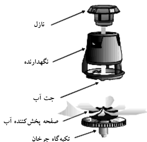
شکل ۲- اجزا نازل دوار شرکت نلسون.
