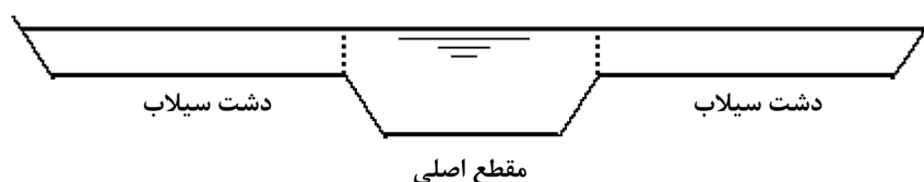
شکل ۲- مقطع مرکب و تجزیه آن به مقطع اصلی و دشت‌های سیلابی.
