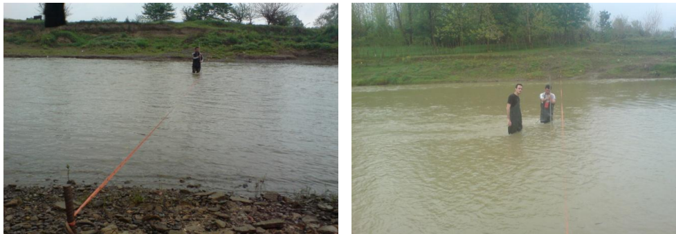
شکل ۴- نمایی از مقاطع انتخابی رودخانه پسیخان و نحوه اندازه‌گیری سرعت توسط سرعت‌سنج پروانه‌ای.
