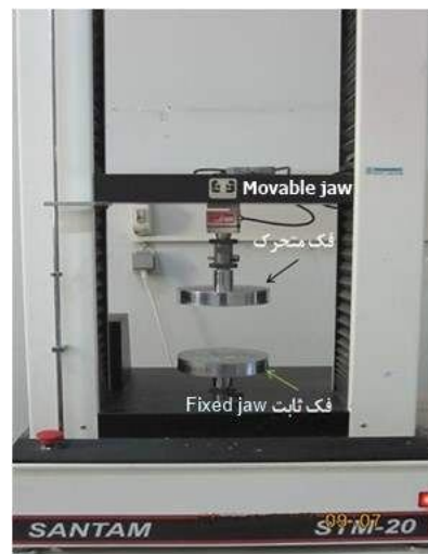
شکل ۱- دستگاه اینسترون و موقعیت قرارگیری نمونه بین دو فک دستگاه.
