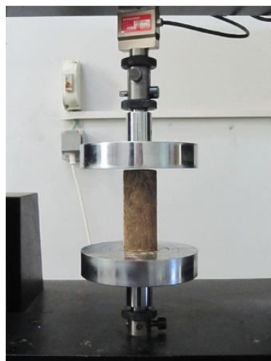
شکل ۱- دستگاه اینسترون و موقعیت قرارگیری نمونه بین دو فک دستگاه.
