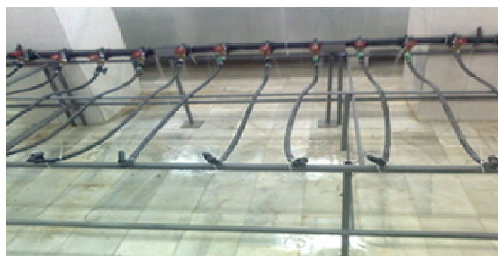
شکل ۱- نمای کلی از مدل فیزیکی آبیاری قطره‌ای.
