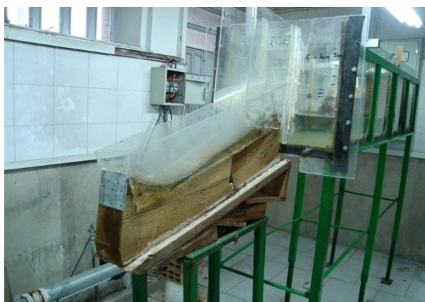
شکل ۳- مدل آزمایشگاهی سرریز سد بالارود.
