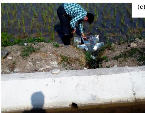
شکل ۵- فلوم RBC ۱۰۰ میلی‌متری: الف) طرح شماتیک و ابعاد فلوم، ب) کالیبراسیون فلوم و پ) اندازه‌گیری دبی در کانال بتنی.
