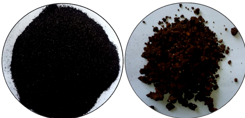
شکل ۱- لجن خام فاضلاب صنعتی هواخشک قبل (راست) و بعد از تبدیل به زغال زیستی (چپ).
