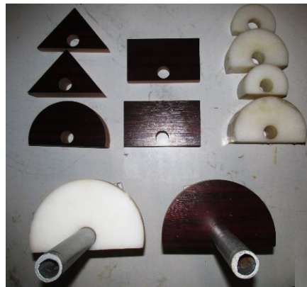
شکل ۴- چند نمونه از مدل اجسام شناور با هندسه‌های مختلف به کار رفته در پژوهش. Figure 4. Sample debris with different geometries used in this research.
