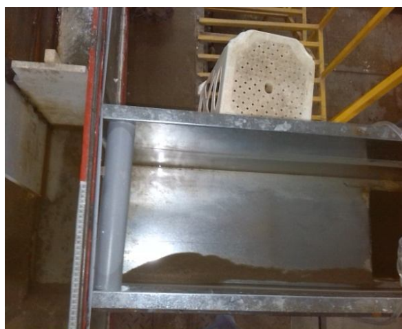
شکل ۴- ته‌نشینی و توزیع رسوبات در طول کانال آبیگر.
