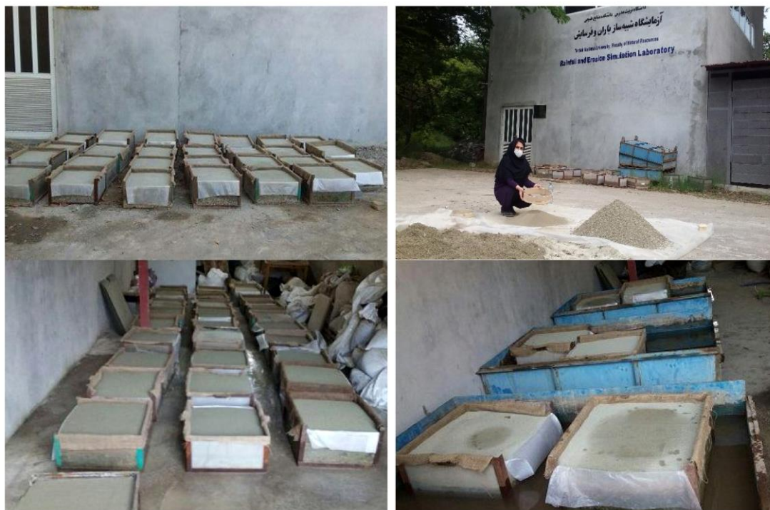
شکل ۱- مراحل الک کردن خاک (بالا و راست)، انتقال خاک به داخل کرت‌ها و غلطک زدن و تسطیح خاک (بالا و چپ)، شرایط اشباع از کف (پایین و راست) و خارج کردن کرت‌ها از شرایط اشباع (پایین و چپ).
