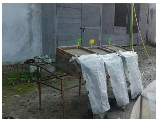
شکل ۲- مراحل شبیه‌سازی باران (راست) و ظرف‌های جمع‌آوری رواناب و هدررفت خاک از خروجی کرت (چپ).
