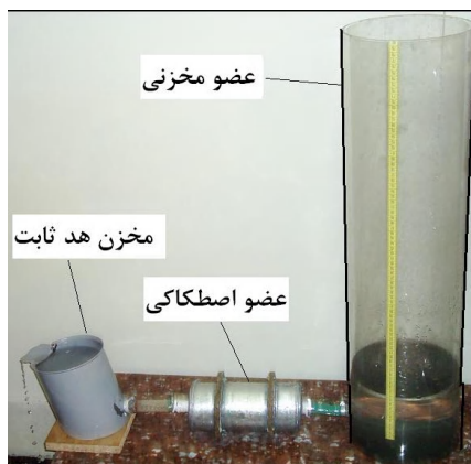
شکل ۵ یک مدار مدل آنالوگ مایع
