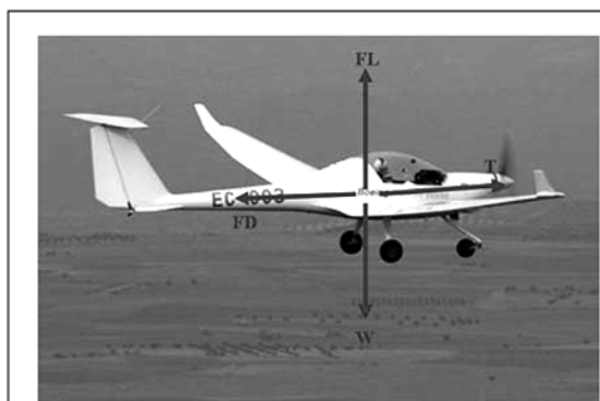
شکل ۱ نیروهای وارد بر یک هواپیما. نیروهای پیشران، بالابر، پسا و وزن به ترتیب با T ، FL ، FD و W نشان داده شده‌اند.
