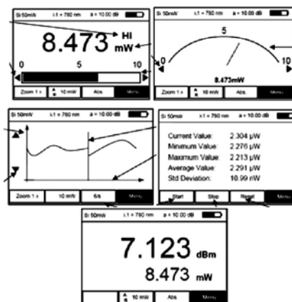
شکل ۱۰ صفحه نمایشگر توان‌سنج نوری به صورت‌های عددی، عقربه‌ای، گرافیکی، آماری و dBm [۱۶]
