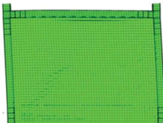
شکل ۵. نمودار نیرو-تغییر مکان و مدل اجزا محدود دیوار بنایی با کلاف فولادی بعد از تحلیل
