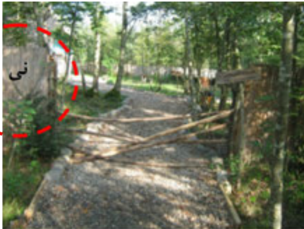
شکل ۸. مصالح مورد استفاده جهت تمایز فضای داخل خانه (حیاط) و گذر عمومی، نی می‌باشد. نی نه تنها بوم آورد و در دسترس است بلکه جهت تهویه و دفع رطوبت هم مناسب است.
