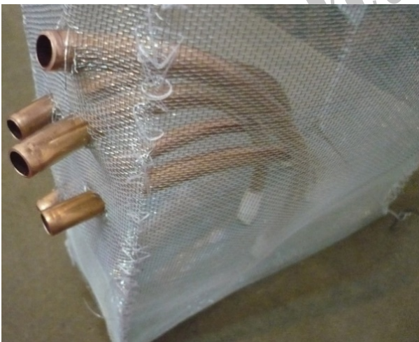
شکل ۸. جای‌گیری لوله‌های مسی سامانه
