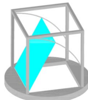
شکل ۷. منعکس کننده‌های تعبیه شده بر روی سقف آتریوم
