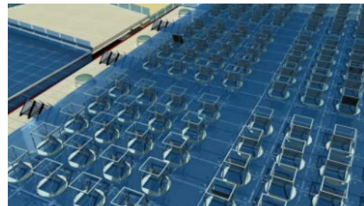
شکل ۹. چیدمان منعکس کننده‌های قابل تنظیم، روی سقف آتریوم
