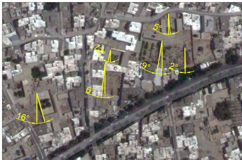
شکل ۹. خانه‌های تاریخی محله دردشت- خیابان ابن سینا از راست به چپ: قادریان- بدیع‌الصنایع- حبیب‌آبادی- کدخدایی- هریتاش- نیلفروشان جهت‌گیری خانه بیشتر رو به جنوب است و به نظر می‌رسد که اندک چرخش به سمت شرق و غرب در اثر وضعیت کوچه‌ها و خانه‌های کناری ایجاد شده باشد.
