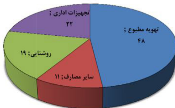
شکل ۱. ترازنامه انرژی در یک ساختمان اداری نمونه. (مأخذ: سازمان بهره‌وری انرژی ایران (سابا)، ۱۳۹۲)
