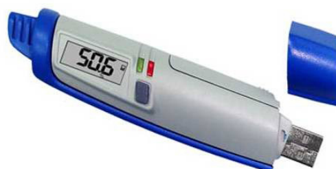
تصاویر ۳ و ۴ - دستگاه دیتالاگر دما و رطوبت (سمت راست) - بادسنج (سمت چپ).
