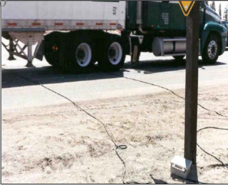
شکل (۵). به کارگیری لوله فشار برای اندازه‌گیری سرعت در پایین دست تونل [۲]
