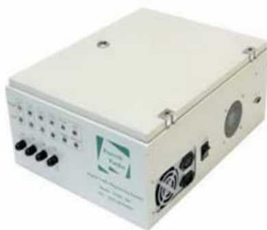
شکل یک: تصویر دستگاه آشکارگر مکانیزه حلقه القایی مدل DTRS-001
