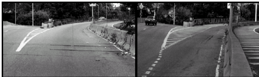
شکل یک: خط‌کشی طولی که باعث محدود کردن مسیر حرکت خودرو می‌شود (Bryan.J,2004)
