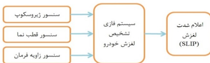
شکل ۳- شمای سیستم تشخیص شدت لغزش خودرو
