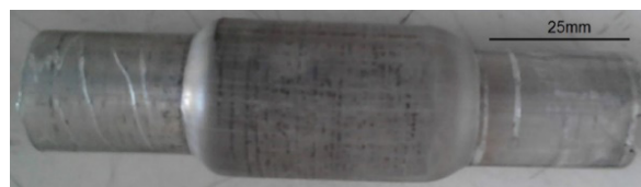
شکل ۱۶: لوله‌ی پله‌ای استوانه‌ای شکل داده‌شده با مسیر بارگذاری بهینه
